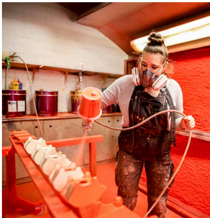
Die ausgesägten Sparschweinchen wurden gefräst, verleimt, geschliffen und lackiert.
